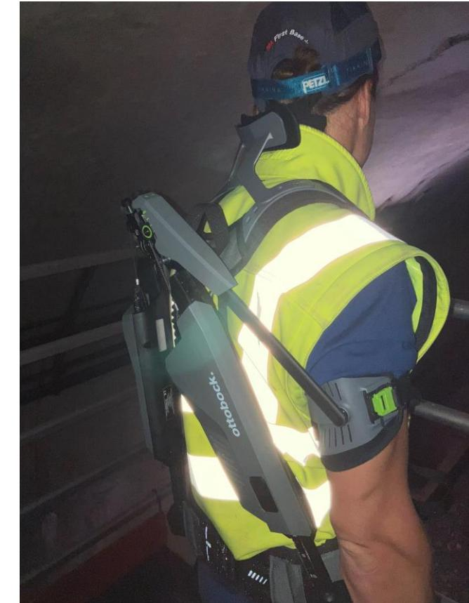
Exoskelett zur Unterstützung bei Bauwerksuntersuchung
